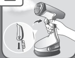
**IT** Per un getto di vapore continuo, bloccare il pulsante di uscita del vapore con l'apposito interruttore. Per rilasciarlo, spingerlo verso l'alto.
