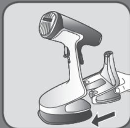
**IT** Riposizionare il serbatoio dell'acqua nell'apparecchio. Assicurarsi che il serbatoio dell'acqua sia posizionato correttamente e bloccato.
